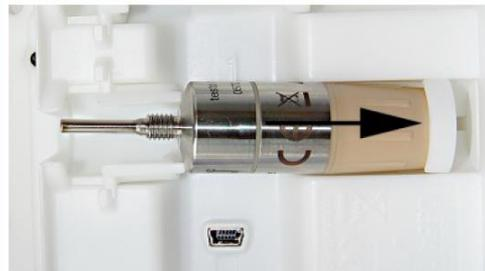
▶ O data logger é inserido corretamente se o anel isolador estiver entre os dois contatos de comunicação.
