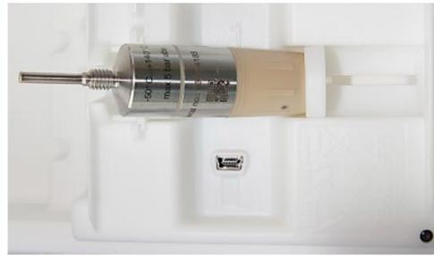
3 Empurre o data logger na direção da seta e encaixe no adaptador de distância.
